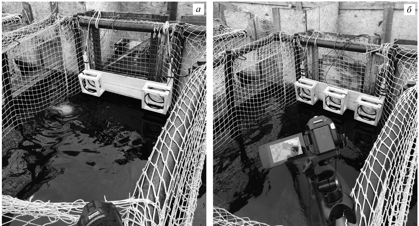
Рис. 2. Экспериментальный стенд: а – вариант с двумя парами катушек; б – вариант с тремя парами катушек. Fig. 2. Experimental stands: a – variant with two pairs of coils; b – variant with three pairs of coils.
